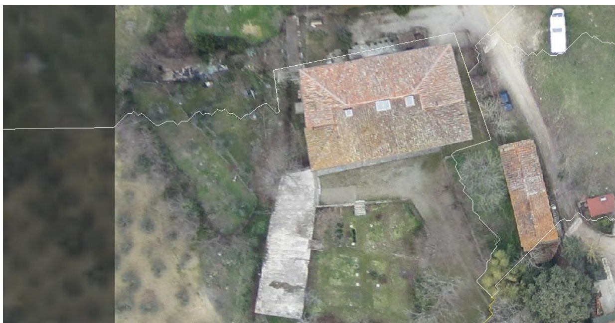
Esempio di editing sulle seamlines: edificio incluso in un'unica immagine
